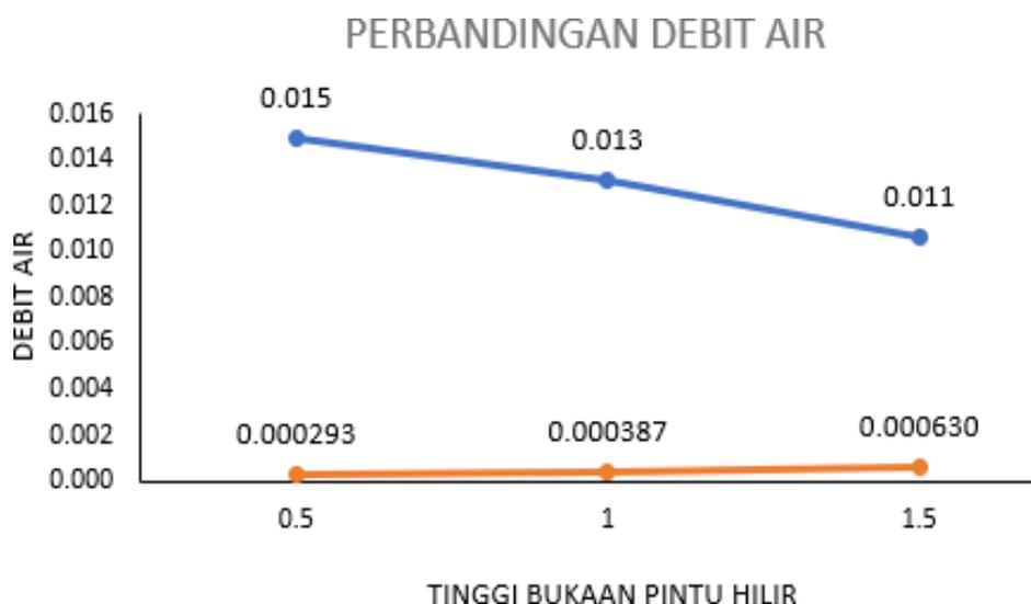
Gambar 2. Grafik perbandingan debit saluran dengan debit menggunakan ambang
